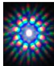
回折格子シートを重ねる枚数でスペクトルが見られる
